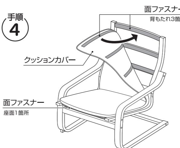
すべてのフレームを取り付けたら、「クッションカバー」を「背・座フレーム」に取り付けます(背もたれと座面の一部は面ファスナーで取り付けてください)。
